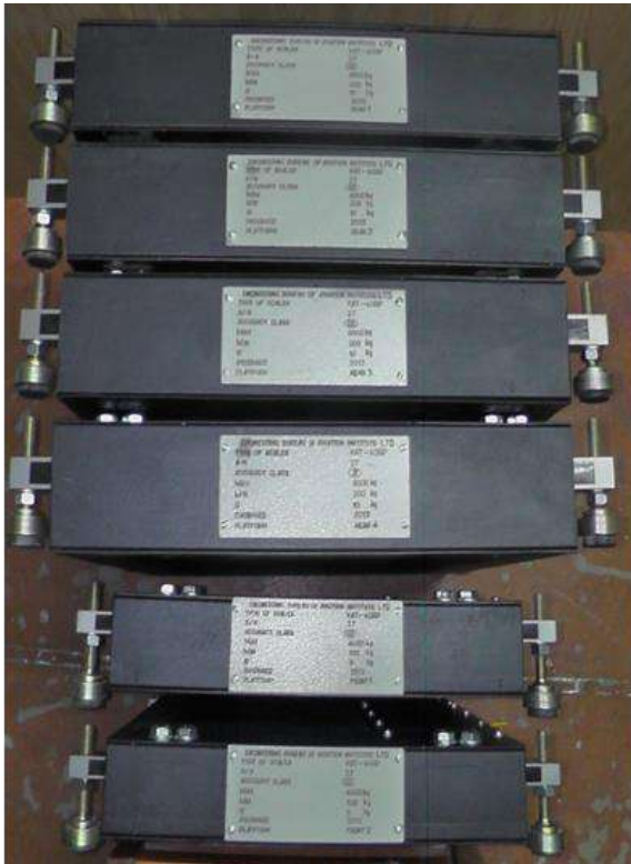
Рис. 1. Комплект ваговимірювальних платформ авіаційних ваг ВАТ-40РП
