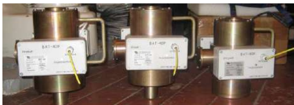
Рис. 2. Комплект вимірювальних блоків авіаційних ваг ВАТ-40Р
