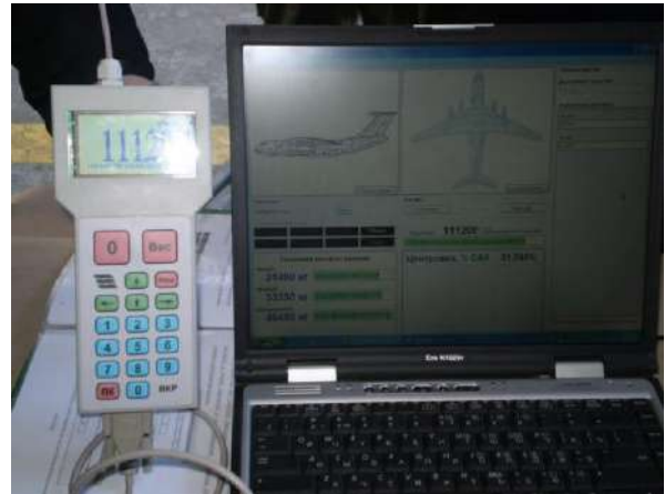
Рис. 3. Ваговий термінал авіаційних ваг, підключений до ПК
