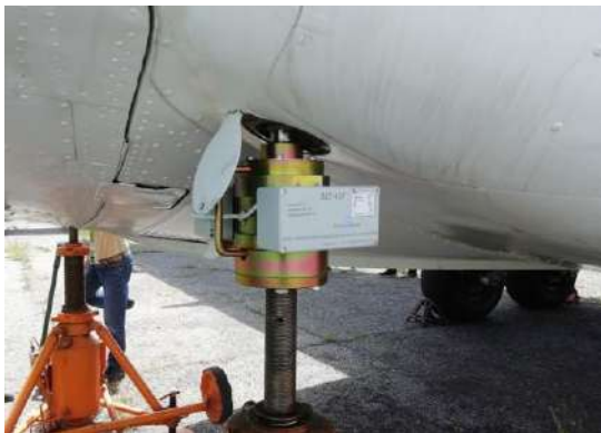
Рис. 8. Вимірювальний блок стійкових авіаційних ваг, встановлений на гідропідіймач
