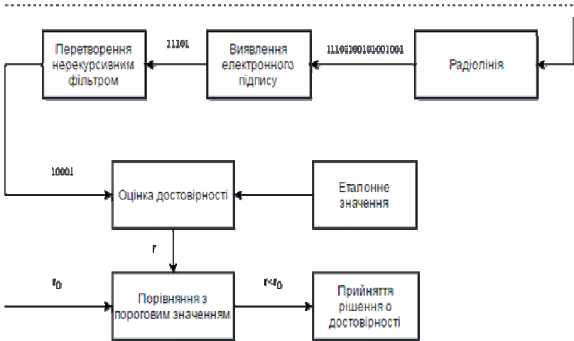
Рисунок 3 – Блок прийому повідомлення електронного підпису ( r_0 – гранична кодова відстань, r – кодова відстань)
