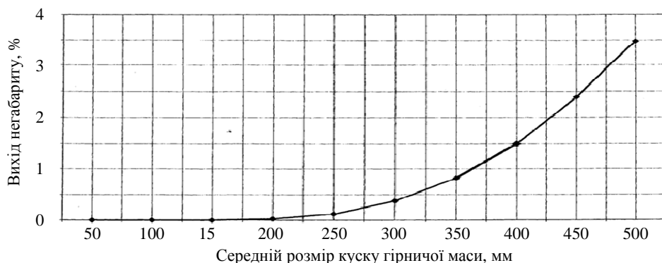
Рис. 1. Залежність виходу негабарита від середнього діаметра куска гірничої маси, авторська розробка
