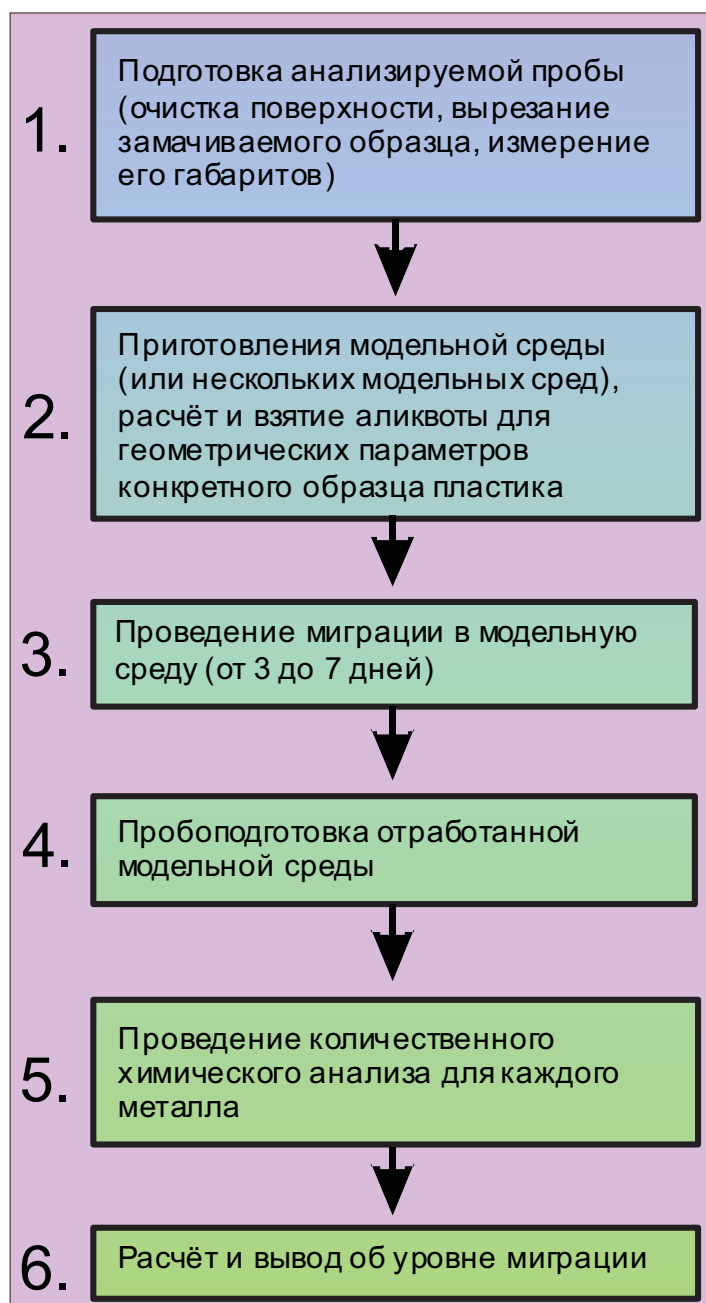
Рис. 1. Схема проведения исследования миграции металлов из полимерных изделий, контактирующих с пищевыми продуктами, а также из синтетической одежды, обуви и детских полимерных игрушек согласно СанПиН 42-123-4240-86.
