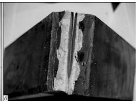
Рис. 3. Характерные изломы сварных соединений рельсовой стали с V- (a) и U-образной (б) формами разделки, выполненных с предварительным подогревом до 150 °C на погонной энергии 8,6 кДж/см после испытаний на трехточечный изгиб
