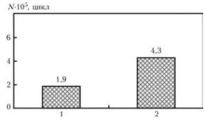
Рис. 6. Влияние V- (1) и U-образной (2) форм разделки на циклическую долговечность сварных соединений рельсовой стапи
