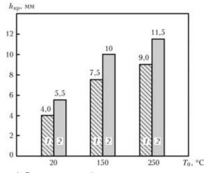
Рис. 4. Влияние погонной энергии сварки и температуры предварительного подогрева на критическую деформацию сварных соединений рельсовой стали с U-образной формой разделки: I - 8.6; 2 - 28.5 кДж/см
