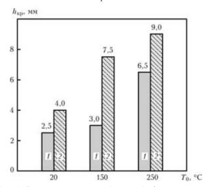
Рис. 2. Влияние V- (I) и U-образной (2) форм разделки и температуры предварительного подогрева  $T_0$  на критическую деформацию сварных соединений  $h_{\rm kp}$  рельсовой стали, выполненных на погонной энергии сварки  $Q_{\rm cg}=8,6$  кДж/см
