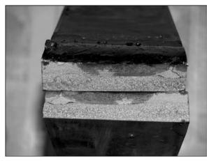
Рис. 8. Поверхность излома сварного соединения рельсовой стали с U-образной формой разделки, выполненного с предварительным подогревом до 250 °C на погонной энергии 28,5 кДж/см после циклического нагружения изгибом
