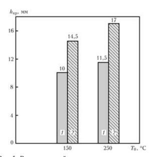
Рис. 5. Влияние условий послесварочного охлаждения на критическую деформацию сварных соединений рельсовой стали с U-образной формой разделки, выполненных на погонной энергии 28,5 кДж/см: I — охлаждение на воздухе при 20 °C; 2 — охлаждение в термокамере со скоростью 50 °C/ч
