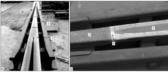
Рис. 1. Сварная железнодорожная крестовина с рельсовым окончанием: a — общий вид;  $\delta$  — участок в месте сварки сердечника с рельсовым окончанием: l — участок крестовины в месте сварки сердечника с рельсовым окончанием; 2 — место разрушения рельсового окончания; 3 — сердечник из стали  $110\Gamma13$ ; 4 — вставка из стали 10X18H10T; 5 — рельсовое окончание из стали M76
