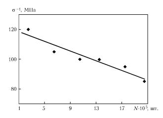
Рис. 7. Влияние напряжений цикла на циклическую долговечность сварных соединений рельсовой стали с U-образной формой разделки, выполненных с предварительным подогревом до  $250~^{\circ}$ C на погонной энергии 28,5~ кДж/см
