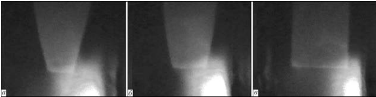
Рис. 4. Фотографии (светофильтр ИКС-5) плоскозаточенного электрода диаметром 5 мм с шириной рабочей кромки 1 ( а ), 2 ( б ) и 5 ( в ) мм и дугового промежутка в условиях СУЗ при I_{cb} = 400 А
