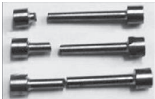
Рис. 11. Образцы сварных соединений сплава Ti–47Al–2Cr–2Nb после испытаний на разрыв
