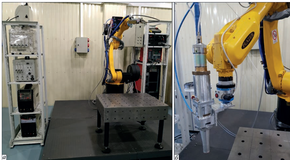
Рис. 2. Зовнішній вигляд лабораторного роботизованого комплексу (а) і головка для лазерного різання (б) в руці робота
