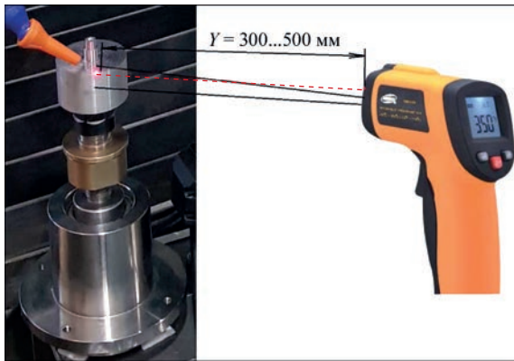
Рис. 8. Схема вимірювань температури нагрівання зразків після зварювання за допомогою ручного інфрачервоного пірометра (штрихова лінія візуалізує лазерний приціл)
