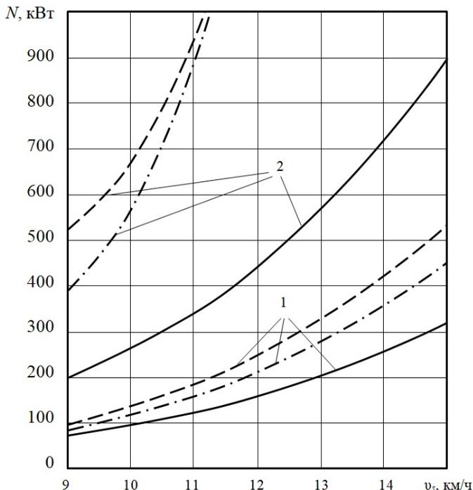
Рис. 3. Характеристики самоходного судна-толкача при различных отношениях  $H/T$ : 1 – с одной баржей; 2 – в составе каравана типовых барж; — — — — —  $H/T = 4$  (глубокая вода); - - - - -  $H/d = 1,6$ ; - · - · -  $H/d = 1,35$ ;  $N$  – мощность, вырабатываемая главным двигателем;  $v_s$  – скорость состава
