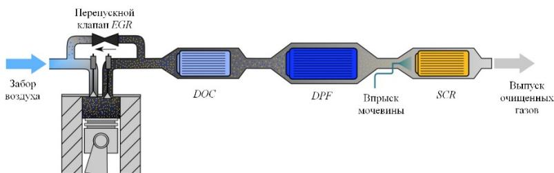
Рис. 5. Схема системы очистки выхлопных газов [6]
