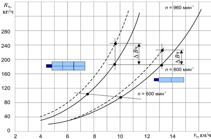
Рис. 4. Изменение расхода топлива главных двигателей толкачей типа «Запорожье» при разных формах составов и при выходе на мелководные участки [2]:  $B_{ч}$  — часовой расход топлива;  $v_c$  — скорость состава
