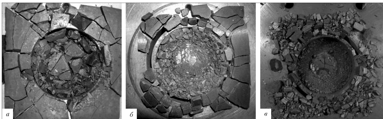
Рис. 6. Характерный вид разрушения при круговом изгибе образцов, нагруженных ударом сферическим ударником: а – v = 57 ; б – 101 ; в – 245 \text{ м/с}
