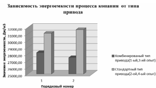
Рис. 4. Диаграмма зависимости энергоёмкости процесса копания от типа привода
