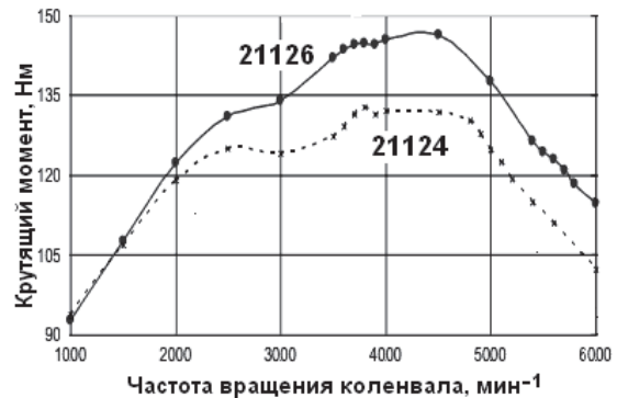
Рис. 2. Кривая крутящего момента двигателей VA3-21124 и VA3-21126
