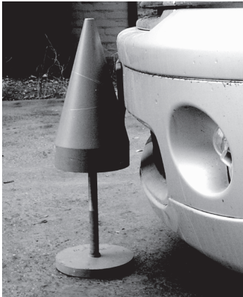
Фото 3. Визначення “лінії підлоги” за ГОСТ 28557-90 (Правила ЕЭК ООН № 26)
