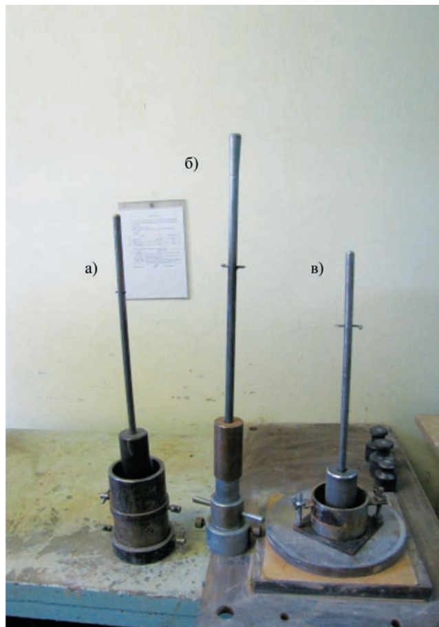
Рис. 3. Прилади стандартного ущільнення ґрунтів: а) за ДСТУ Б В.2.1–12; б) згідно з СН 25–74; в) той, що пропонується
