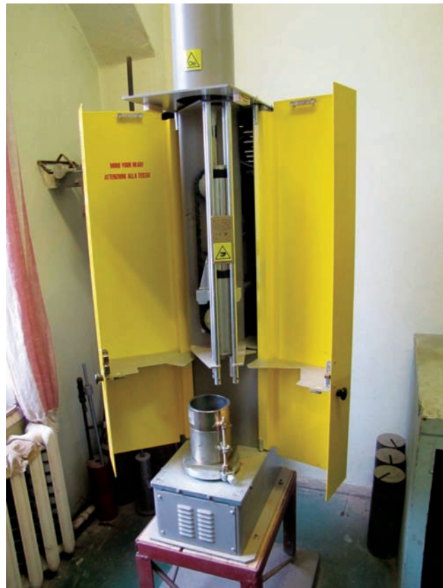
Рис. 2. Вигляд сучасного трамбуючого пристрою для підготовки зразків за методом Проктора, AASHO і для випробування на CBR
