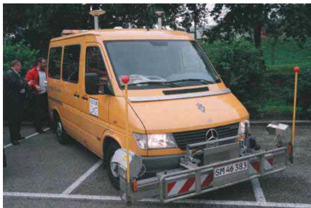
Рис. 1. Профілограф “Profilograph III”, Дорожній дослідницький інститут, Данія
