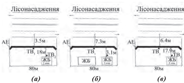
Рис. 1. Геометрична конфігурація досліджуваної ділянки автомобільної дороги: ТВ – точка вимірювання; ТВ 1 – 1 м від поверхні екрана, ТВ 2 – 2 м від поверхні фасаду житлової забудови, АЕ – акустичний екран, ЖБ – житлова забудова; (а), (б), (в) – положення 1, 2 та 3 відповідно (див. табл. 1)
