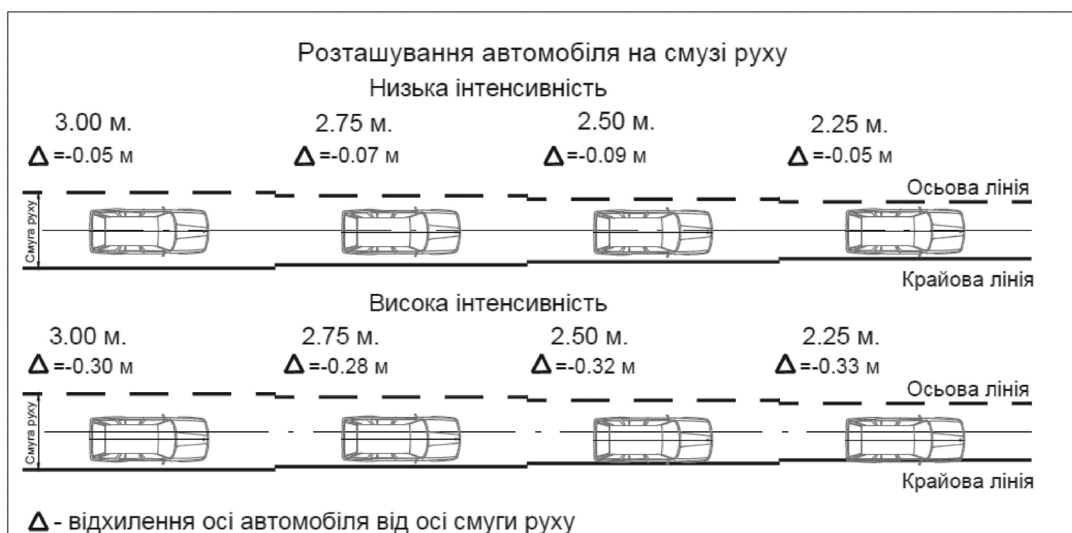
Рис. 3. Положення автомобіля на проїзній частині при різній ширині смуги руху
