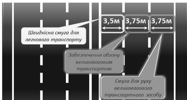
Рис. 2. Ширина смуги руху для автомобільних доріг з трьома і більше смугами руху в одному напрямку
