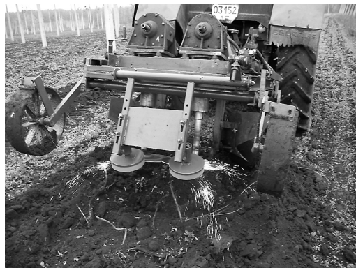
Рис. 1. Вдосконалений обрізувач головних кореневищ маток хмелю ОКХ-1М
