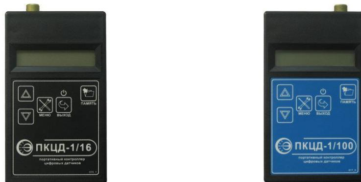
Рис. 2. Портативные контроллеры цифровых датчиков ПКЦД-1/16 и ПКЦД-1/100
