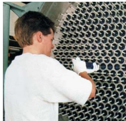
Рис. 5. Конструкція генератора озону Велсбаха
