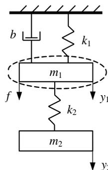
Рис. 1. Схема двух массовой механической системы
