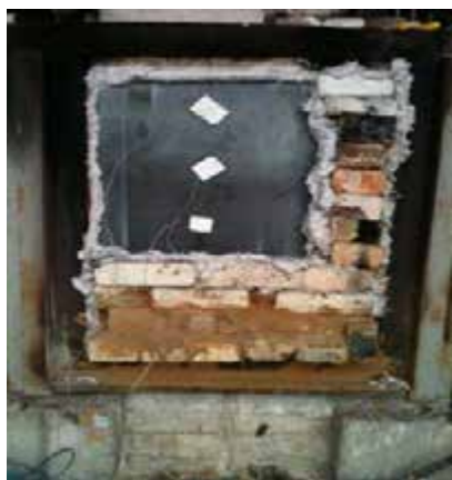
Рис. 4. Схема размещения термопар с необогреваемой поверхности металлической пластины
