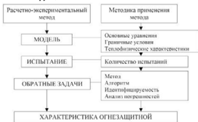
Рис. 1. Алгоритм (схема) применения расчетно-экспериментального метода определения огнезащитной способности покрытий
