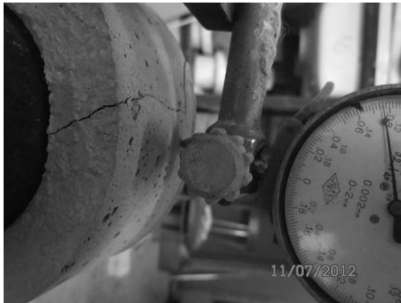
Рисунок 8 - Определение трещиностойкости штукатурного раствора
