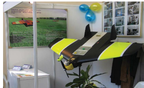
Мал. 3. Загальний вигляд радіокерованого літака R-100 для розселення ентомофагів
