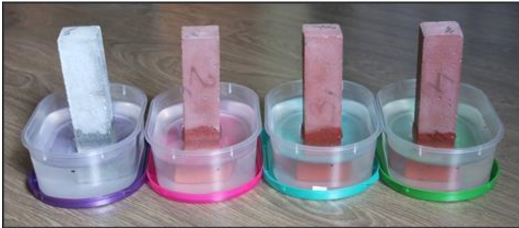
Рис.5. Випробування зразків декоративних шлаколузних дрібнозернистих бетонів на схильність до висолів:
