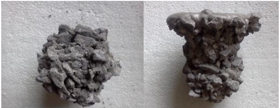
Рис. 2. Експериментальний зразок тіла заповнення, утвореного при статичному та імпульсному нагнітанні розчину в щебеневу структуру ґрунту
