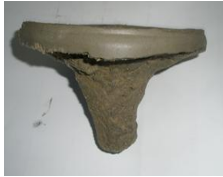
Рис.3. Експериментальний зразок тіла заповнення при статичному та імпульсному нагнітанні технологічного скріпного розчину в пісок
