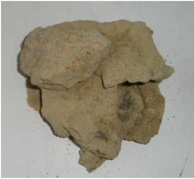
Рис.3. Експериментальний зразок тіла заповнення при статичному та імпульсному нагнітанні технологічного скріпного розчину в пісок
