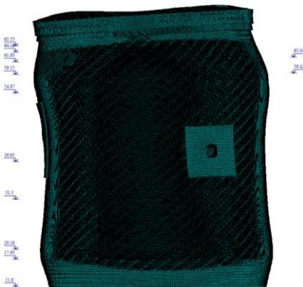
Рис. 4. Деформированная схема цилиндрической части защитной оболочки
