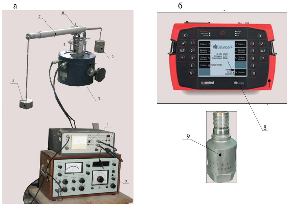
Рис. 1. Общий вид лабораторной установки: а - лабораторная установка в рабочем состоянии; б - портативный виброизмерительный прибор VB8 с акселерометром (9) для полевых испытаний грунта виброштампом; 1-усилитель сигнала; 2-генератор колебаний; 3-вибростол; 4-компрессионный или сдвиговой прибор; 5-грузы для рычажного прибора; 6-индикатор часового типа; 7-рычажное устройство для статического нагружения образца; 8-виброметр VB8; 9-акселерометр (датчик для измерения виброускорения штампа в т. ч. гильзы и стакана)
