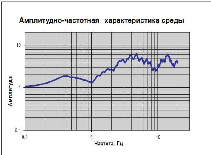
Рис. 3. Амплитудная частотная модели грунтовой толщи под строительной площадкой в г. Одесса по ул. Большая Арнаутская, 26, 28, 30
