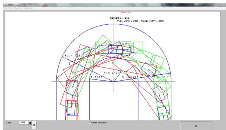
Рисунок 7 - Результати експериментальних досліджень руху автопоїзда при випробуваннях «Рух по колу»
