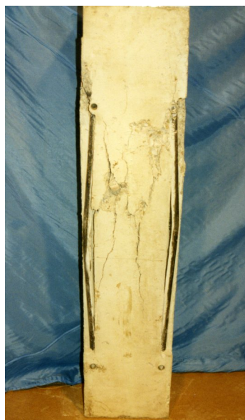
Рисунок 8 - Образцы серии III после испытаний. Два вида разрушения
