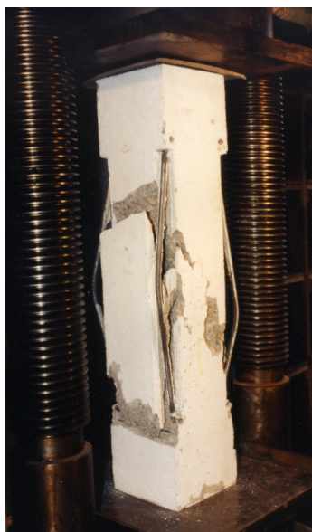
Рисунок 8 - Образцы серии III после испытаний. Два вида разрушения
