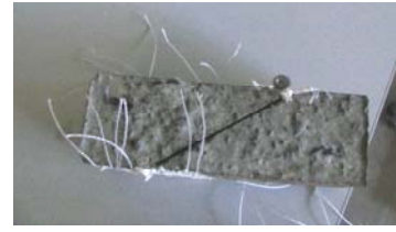
а – фіксація половинок зразків (балочок-призм і циліндрів) з подальшою поверхневою герметизацією в місці проходження шва акриловим герметиком; б – ін’єктування полімерного матеріалу в шов
