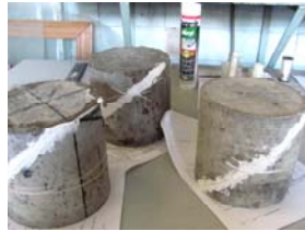
а – фіксація половинок зразків (балочок-призм і циліндрів) з подальшою поверхневою герметизацією в місці проходження шва акриловим герметиком; б – ін’єктування полімерного матеріалу в шов
