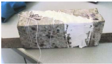
а – фіксація половинок зразків (балочок-призм і циліндрів) з подальшою поверхневою герметизацією в місці проходження шва акриловим герметиком; б – ін’єктування полімерного матеріалу в шов
