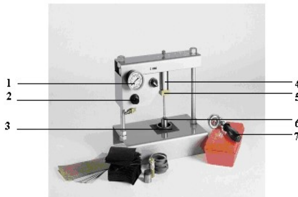
1 – манометр для вимірювання тиску в циліндрі; 2 – регулятор тиску повітря; 3 – пластина з толі або руберойду; 4 – циліндр; 5 – шток циліндра; 6 – гумовий наконечник; 7 – динамометричний ключ
