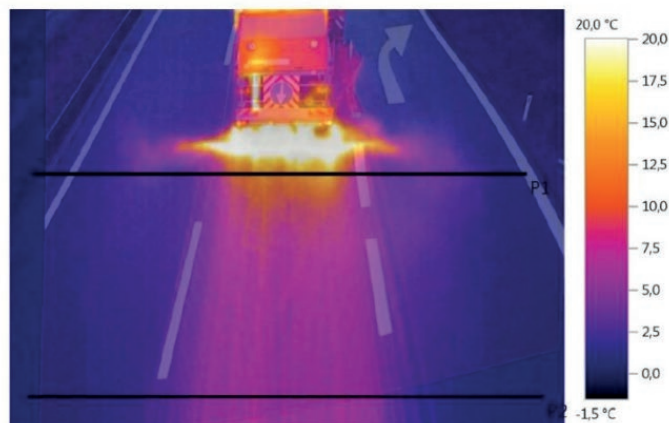
Рисунок 7 — Температура покриття після розподілення розсолу машиною Firestorm
