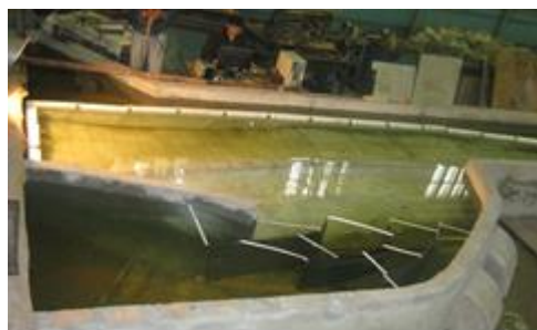
Рис. 2 – Входной участок гидродинамического канала с моделью струенаправляющей завесы
