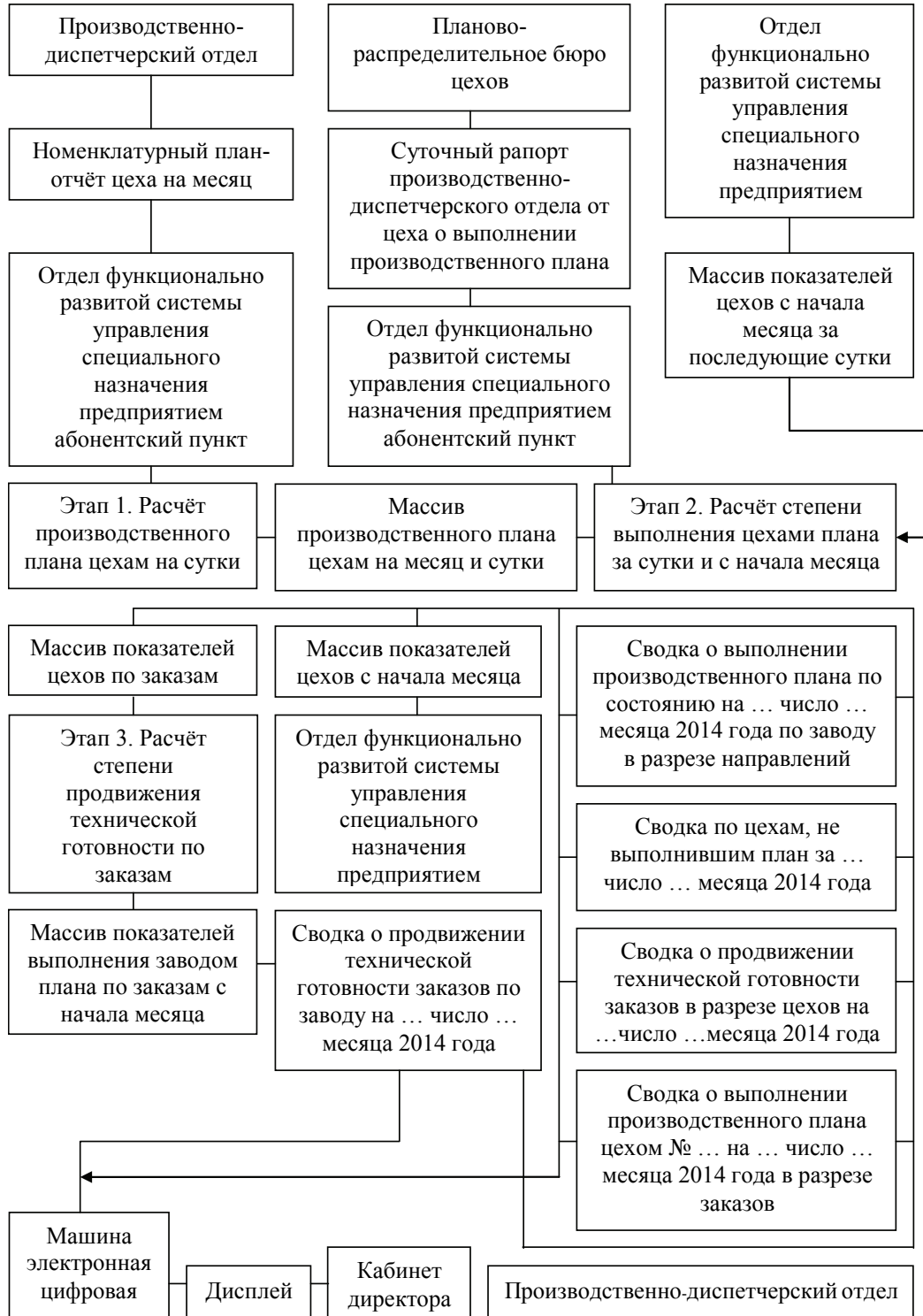
Рисунок 1. Укрупненная блок-схема алгоритма современного решения задачи "Ежедневный анализ выполнения предприятием плана производства"
