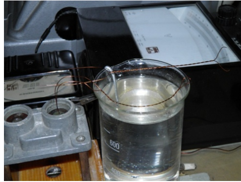
Рис. 1. Газовиділення у місці дефекту ( U_{np}=0,140 кВ; I_e=(5,0 \pm 0,5) мА)
