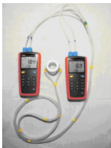
Рис. 1. Комплекс вимірювальний інтраопераційний термопарний чотириканальний (КВІТ-4) (а); універсальна кріохірургічна установка «Кріо-Пульс» (б)
