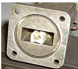
Рис. 2. Расположение ДР в волноводе и измерительной ячейке
