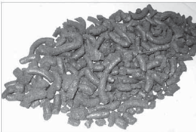
Рисунок 1 – Внешний вид гранулированного сорбента, полученного методом экструзии (связующее – КМЦ)
