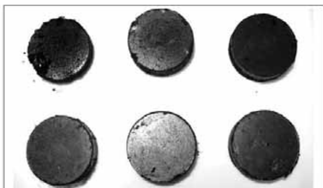
Рисунок 3 – Внешний вид прессованных сорбционных элементов без армирующей сетки
