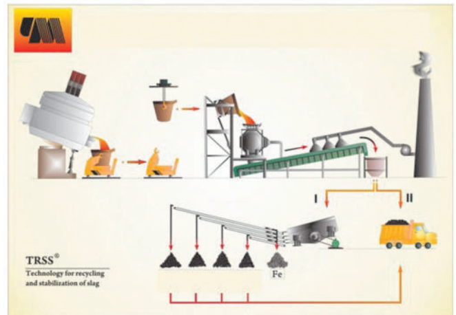
Рисунок 5 – Технологический комплекс переработки и стабилизации жидких сталеплавильных шлаков TRSS
