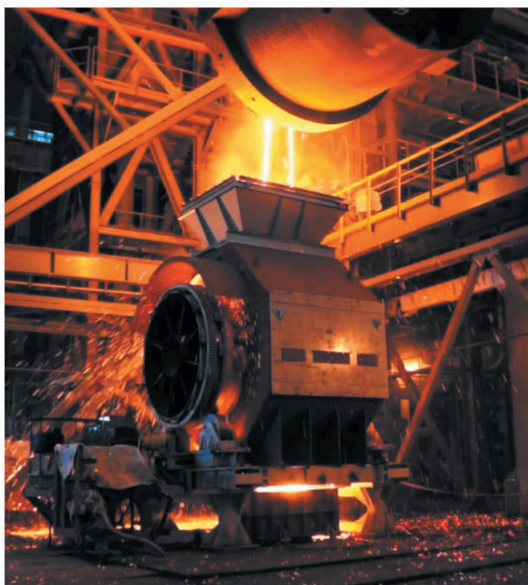
Рисунок 2 – Кристаллизатор барабанный с шаровой насадкой
