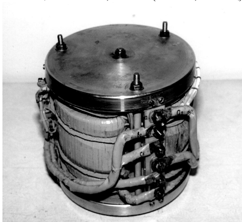
Рис. 5. Трехфазный компактный трансформатор с симметричным пространственным магнитопроводом
