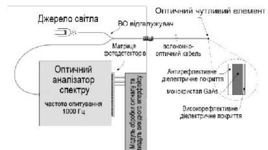
Рис. 3. Схема вимірювання температури за допомогою напівпровідникових перетворювачів на основі кристалу арсеніду галію GaAs (Виробник OPSSENS) [6]
