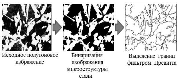
Рис. 2. Результат предварительной обработки изображения микроструктуры стали
