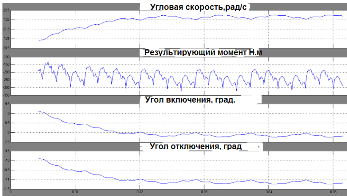
Рис.6. Зависимости угловой скорости, результирующего момента, угла включения \Theta_{on} и угла отключения \Theta_{off} от времени для первого опыта и первого варианта способа изменения углов.
