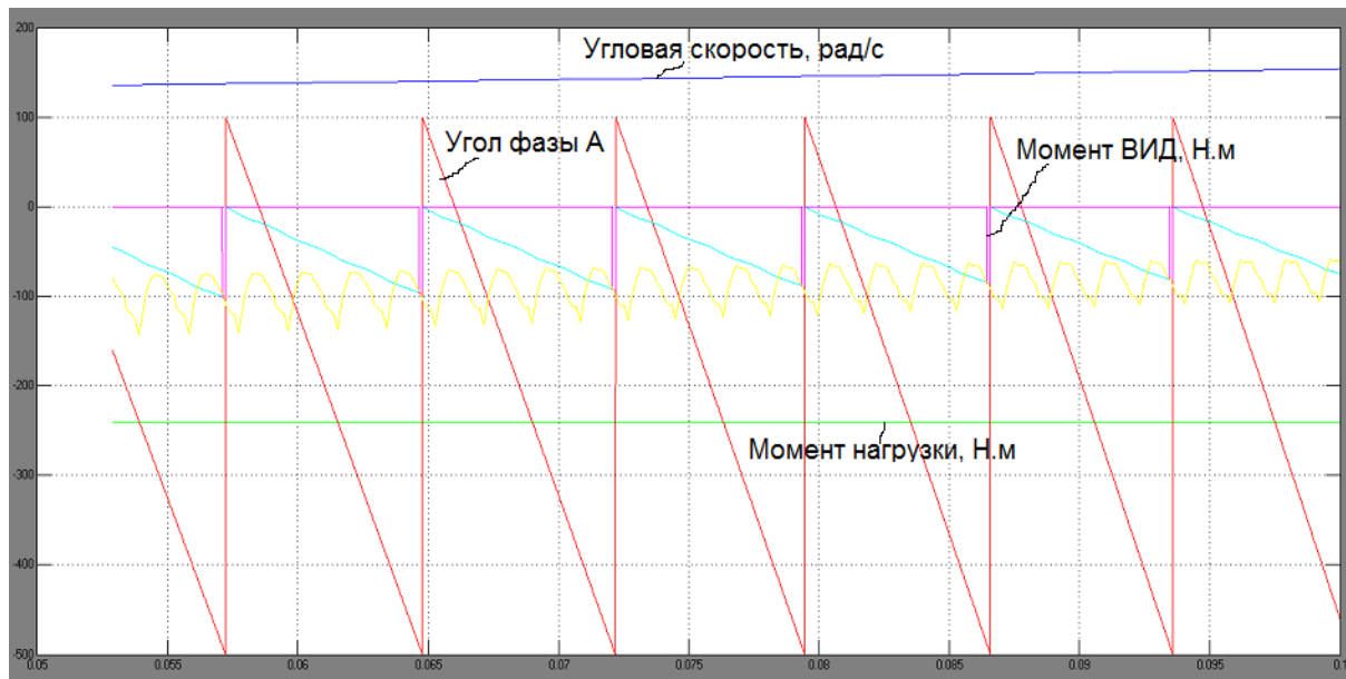
Рис.3. Зависимости угловой скорости, момента нагрузки, момента двигателя и угла фазы А в конце переходного процесса для 2 варианта в таблице 1.
