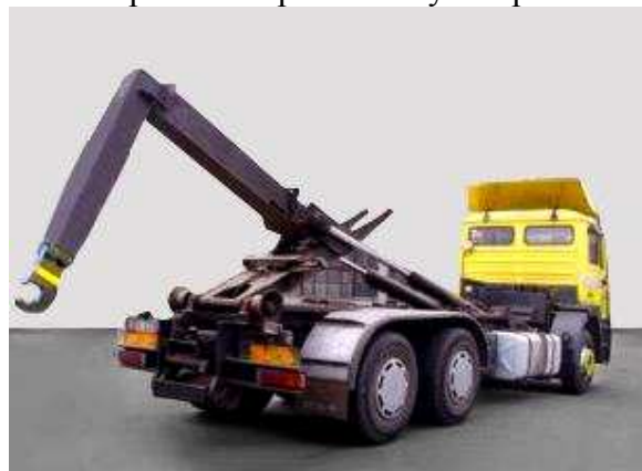
Рис.3. Вантажне шасі з гаковою системою «мультиліфт»
