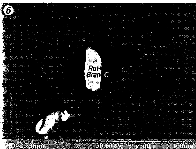
Рис. 9. Метаморфизованное углеродистое вещество (С) в ассоциации с рудными минералами: а – включения антраксолита (С) в браннерит (Bran)-настурановых (Ur) агрегатах, скв. 69, гл. 400 м; б – включения практически полностью замещенного браннеритом (Bran) кристалла рутила (Rut), скв. 70, гл. 348 м. Электронный снимок в формате "Contro".
