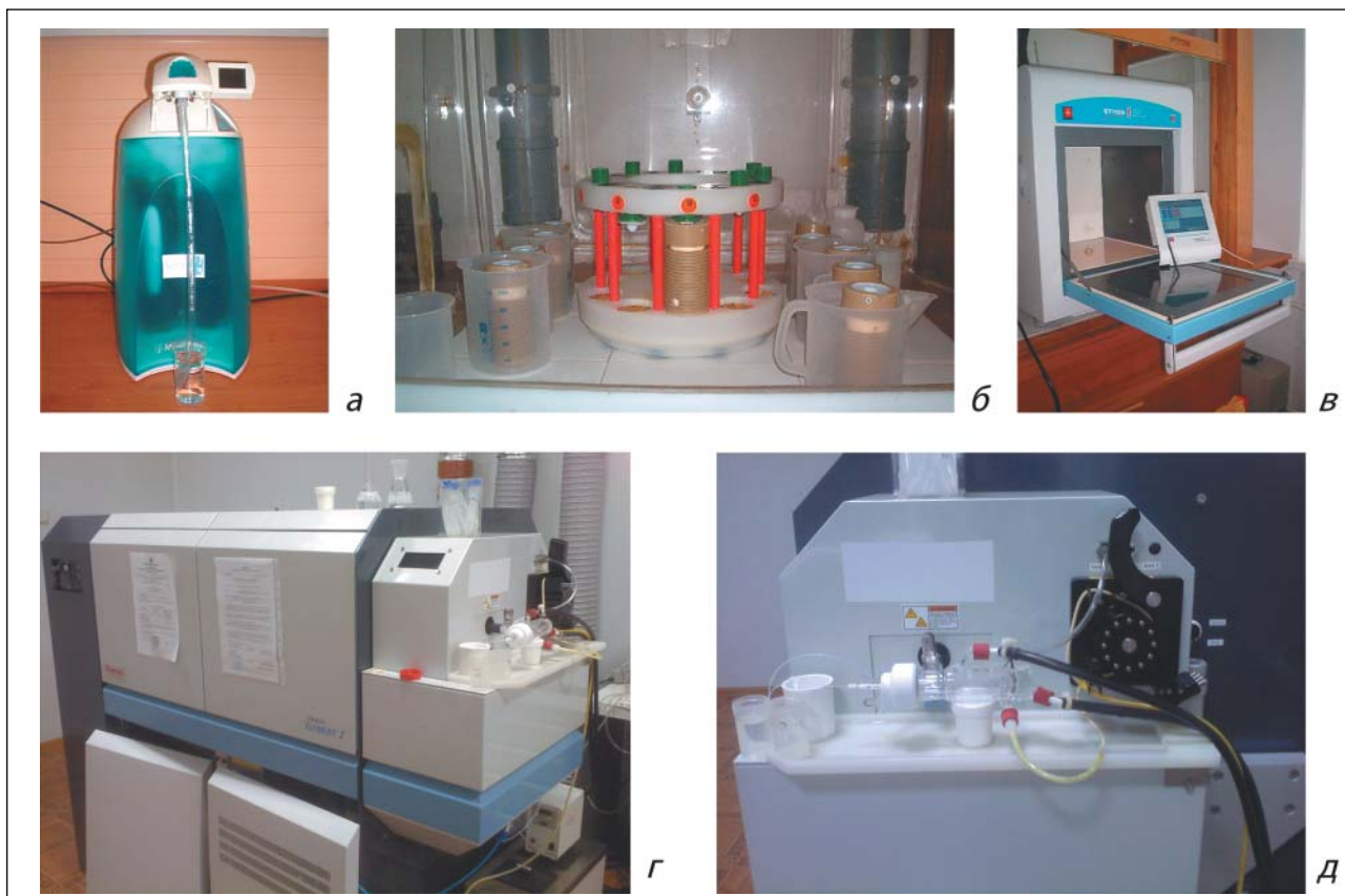
Рис. 1. Прилади для визначення рідкісноземельних елементів в гірських породах та мінералах методом ICP-MS:
