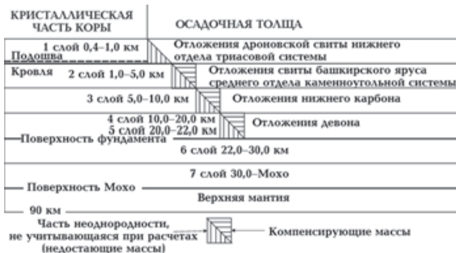
Рис. 3. Структура трехмерной плотностной модели.
